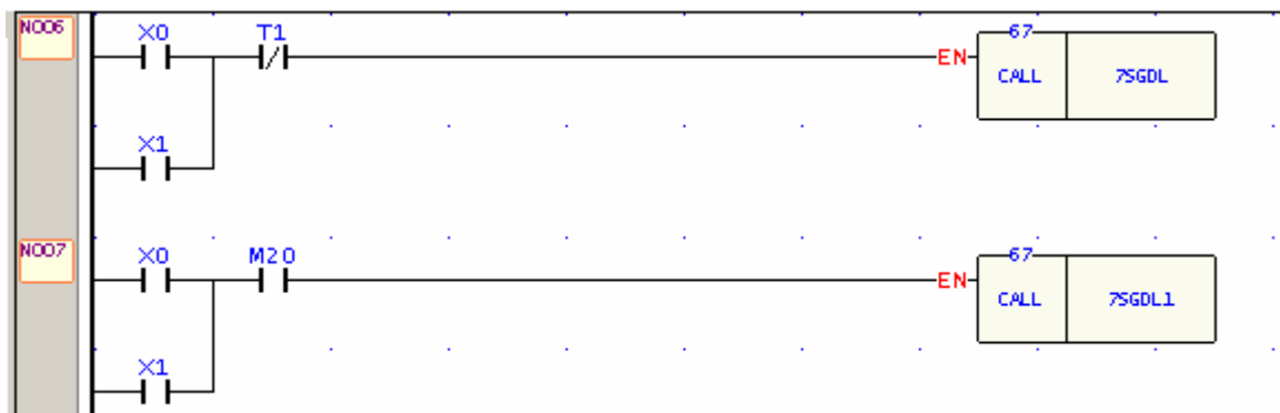
Rys. 1. Programowanie w języku drabinkowym.
